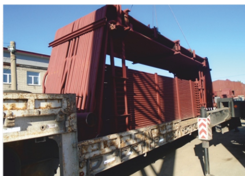
КВ-ГМ-100-150 (топочный блок)
